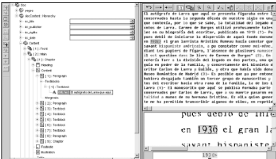
Fig. 7. Verificación de la estructura del documento. A la derecha vemos un bloque de texto: arriba su transcripción por parte del OCR y abajo la imagen original para poder contrastar y corregir, si procede, las palabras que el programa ha marcado como dudosas
